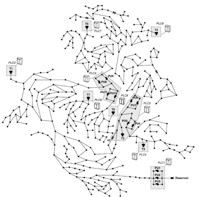
Figuur 5.7: C-town, een van de verschillende water distributie netwerken die binnen DHALSIM gesimuleerd kunnen worden. Uit [73].
